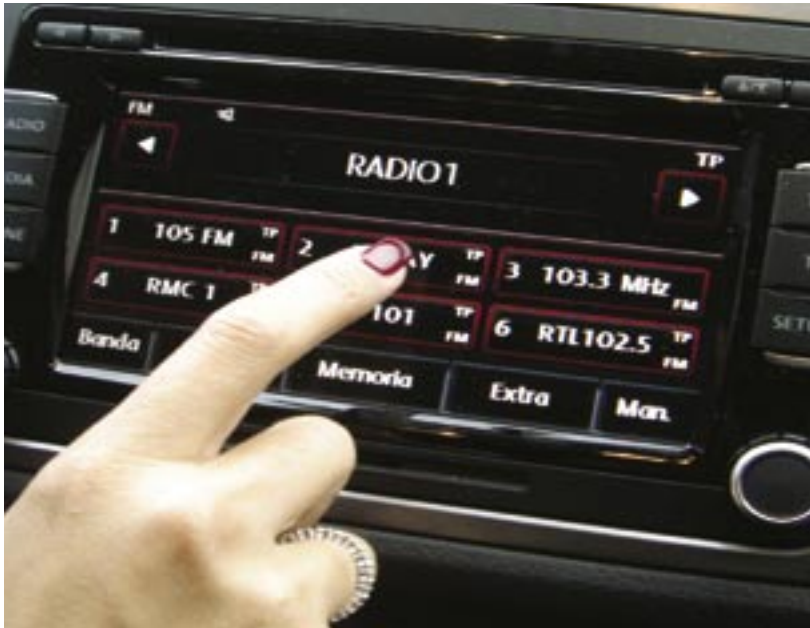
IL TOUCH SCREEN HA SOSTITUITO, IN MOLTI ARTEFATTI TECNOLOGICI, LE PULSANTIERE E I BOTTONI. NELL'IMMAGINE L'INTERFACCIA DI UNA RADIO CON INFORMAZIONI DI TIPO VERBALE E NON PITTORGRAMMATICO
